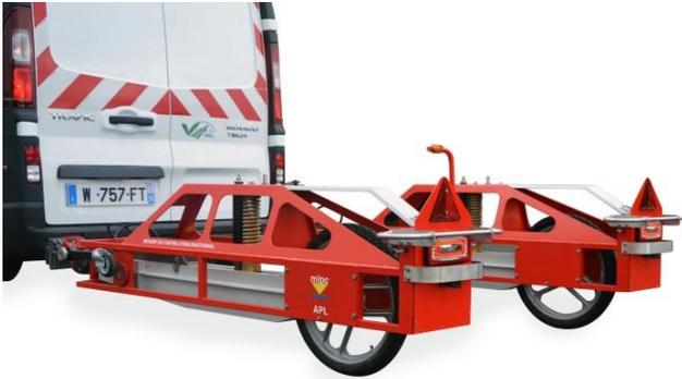
Le système APL -Analyseur de Profil en Long- permet la mesure en continu de l'uni longitudinal des chaussées routières et des pistes aéronautiques et, plus généralement, de toute voie circulaire par des engins automobiles, quelles que soient la structure de la chaussée et la nature de son revêtement.
