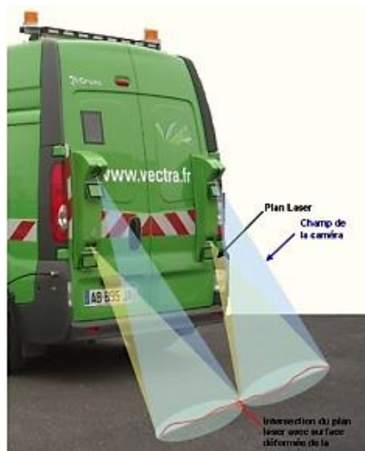
Principe des capteurs du profil transversal
