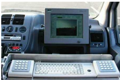
Clavier de relevé de dégradations et d'évènements
