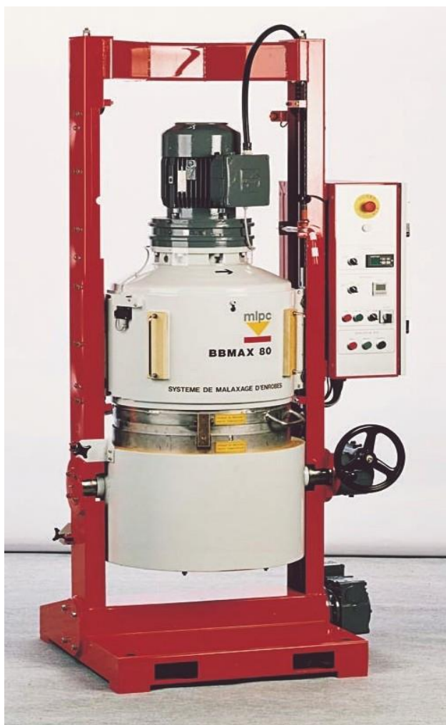
Photo présentant le BBMAX 80. Hauteur maximale, tête remontée : 2..50 m Largeur : 1.20 m Profondeur : 1.00 m Masse : 820 kg
