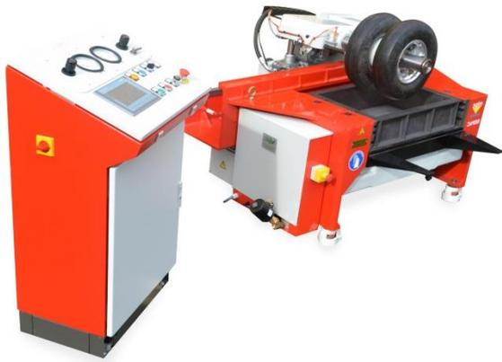
Le compacteur de plaques BBPAC permet de préparer, conformément à la norme NF EN 12697-33 (09/2007), des plaques homogènes de mélanges bitumineux utilisables :
