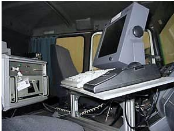
Poste opérateur du Défectographe Lacroix
