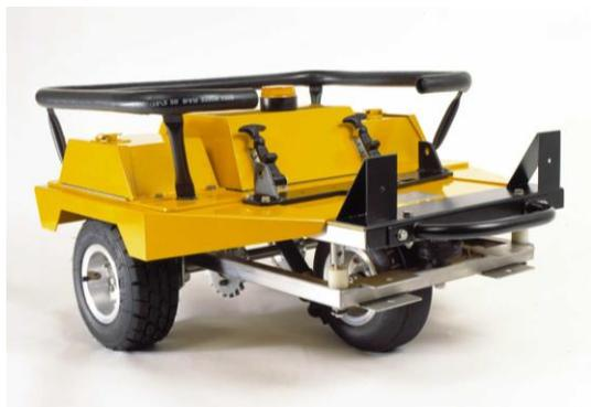
Le GripTester mesure un coefficient de frottement longitudinal (CFL) entre le revêtement et un pneumatique selon le principe d'une roue freinée avec un taux de glissement constant de l'ordre de 15 %. Ce taux de glissement, générateur de la force d'adhérence, est obtenu par entraînement mécanique entre les deux roues porteuses et la roue de mesure.
