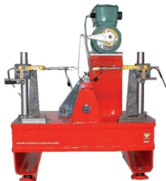
Matériel de laboratoire automatisé, conçu pour réaliser l'essai de résistance à la fatigue sur 2 éprouvettes trapézoïdales de matériaux bitumineux (EN 12697-24 Annexe A 09/2007).
