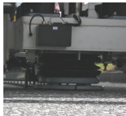
La plaque de chargement coupée en 4 permet un contact total avec la surface et des mesures précises.
