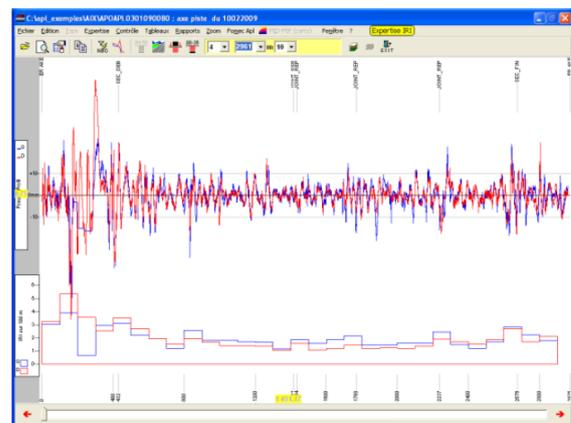
Exemple d'indicateurs de sortie IRI sous APL2015
