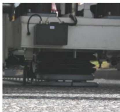
La plaque de chargement coupée en 4 permet un contact total avec la surface et des mesures précises.
